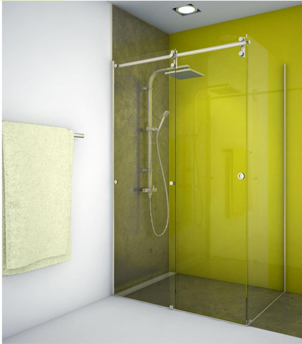
Construction en «L» avec une porte coulissante. Le rail sert de raidisseur à la glace latérale fixe. L'ancrage du raidisseur dans le mur suffit à retenir la glace.
