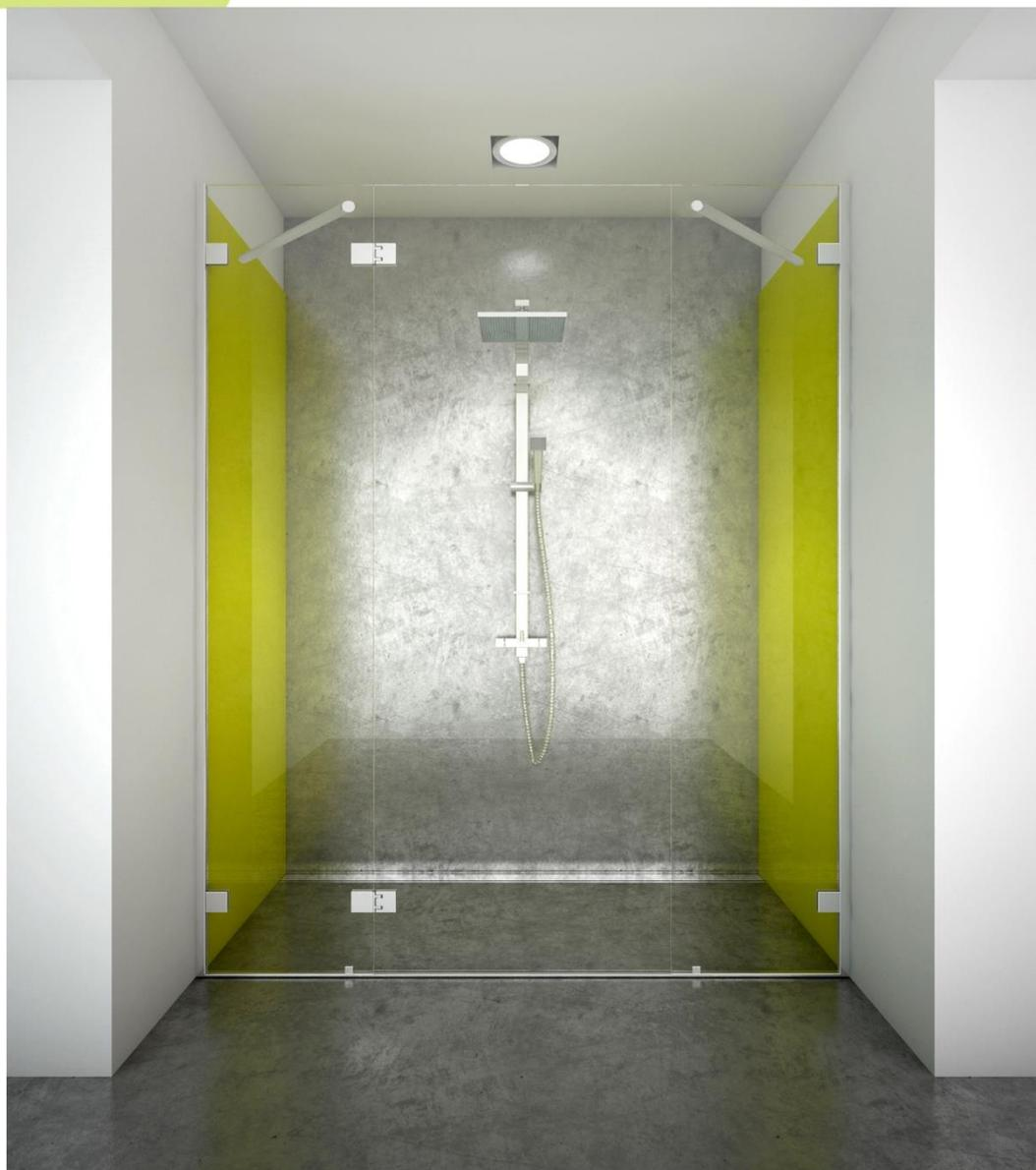
Quand la glace fixe en façade doit-être plus large que 30 cm, il est préconisé de la raidir en partie haute. Un raidisseur orientable permet de limiter l' empiètement sur le volume de la cabine.
