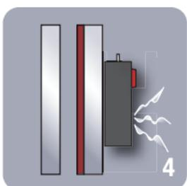
Si vous souhaitez vérifier qu'une unité à double vitrage a été fabriquée correctement et que le revêtement est correctement orienté vers la lame d'air, il suffit de suivre la procédure pour détecter quel panneau de verre possède le revêtement à faible E comme montré aux Figs. 3 & 4 ci-dessus.
