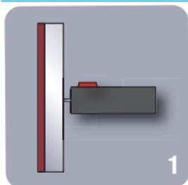
Lorsque les capteurs ne sont pas en contact avec le revêtement à faible E, on n'entendra pas de tonalité.
