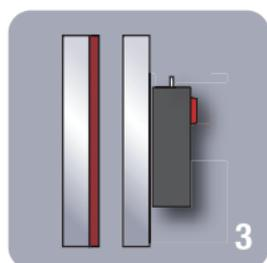
Si l'outil ne détecte pas la présence d'un revêtement à faible E sur le panneau de verre avec lequel l'outil est en contact, aucune tonalité ne sera émise. Si aucune tonalité n'est émise, il suffit de répéter cette procédure de l'autre côté de l'unité comme montré ci-dessous.
