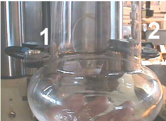
Traçage à la molette sur des machines de gobeletterie. (Photo : BIEBUYCK)
