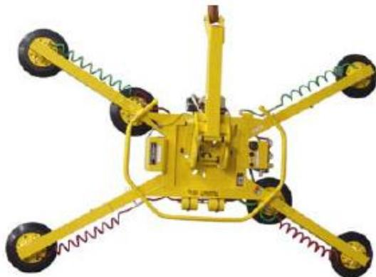
Ce palonnier POWR-GRIP® 6 ventouses à double circuit de vide, basculant (90°) – rotatif (continu sur 360°), grâce à ses 4 bras et 4 ventouses indépendants et amovibles, adopte facilement 8 configurations de levage différentes (de 1.332 x 317 mm à 2.335 x 1.491 mm de surface de préhension).
