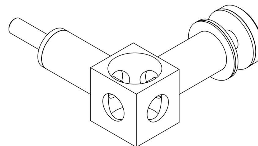
A combiner avec un tube de diamètre 25 taraudé M5 ou M8 à 90°.
